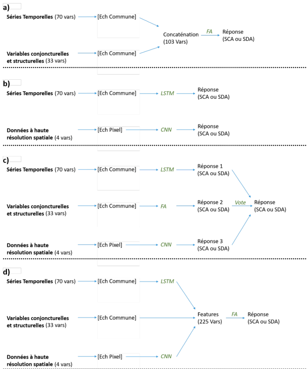
FIGURE 4 – Architecture des quatre types de modèles (a), (b), (c) et (d) utilisés.
