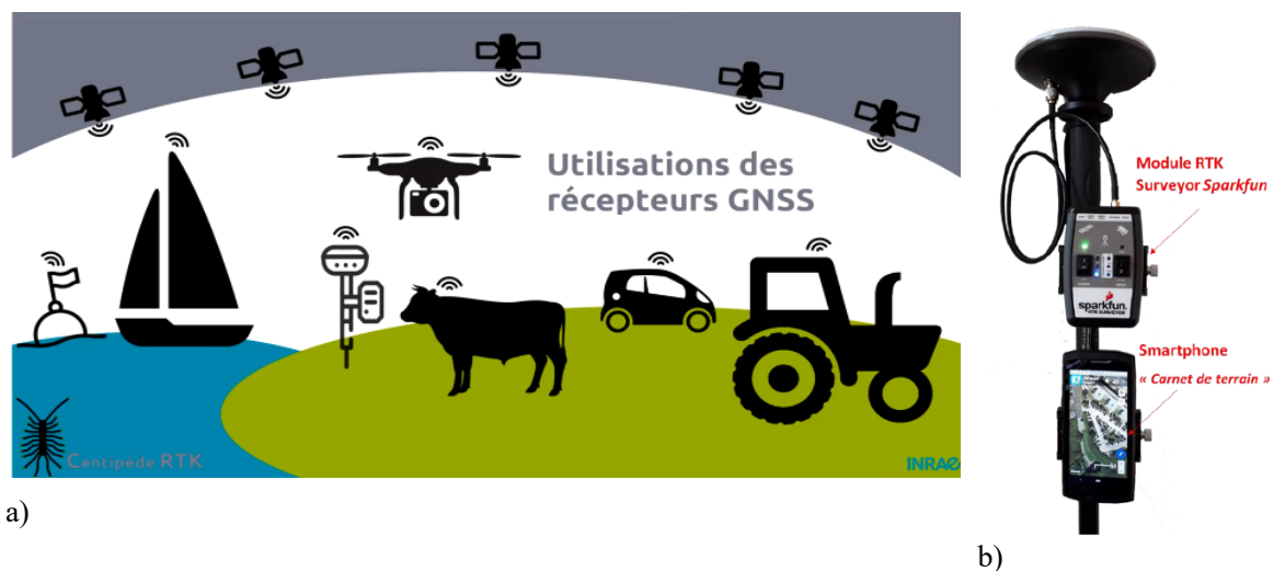
FIGURE 4 – Différents types de rover en fonction des cas d'utilisations (a) et rover de marque Sparkfun équipant une canne (b).
